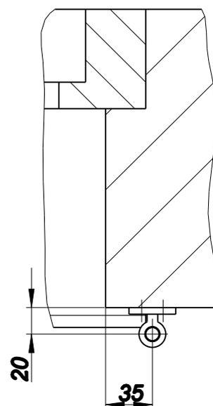
**1. Positionner le gond à 226 mm du linteau et à 35 mm du bord du tableau.
