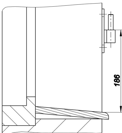
**2. Positionner le gond à 186 mm de la tablette de fenêtre et à 35 mm du bord du tableau.
