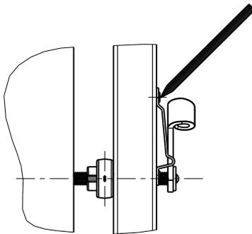
**3. Positionner la platine de blocage de sorte à maintenir le tourniquet légèrement incliné.**
