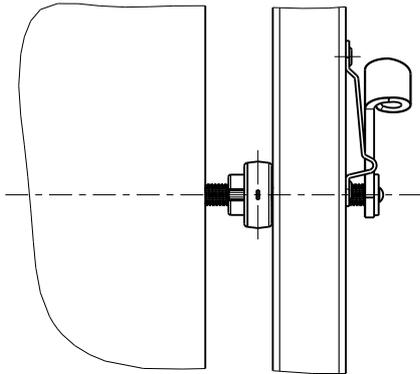
**1. Régler la butée arrière avec un minimum de jeu.
