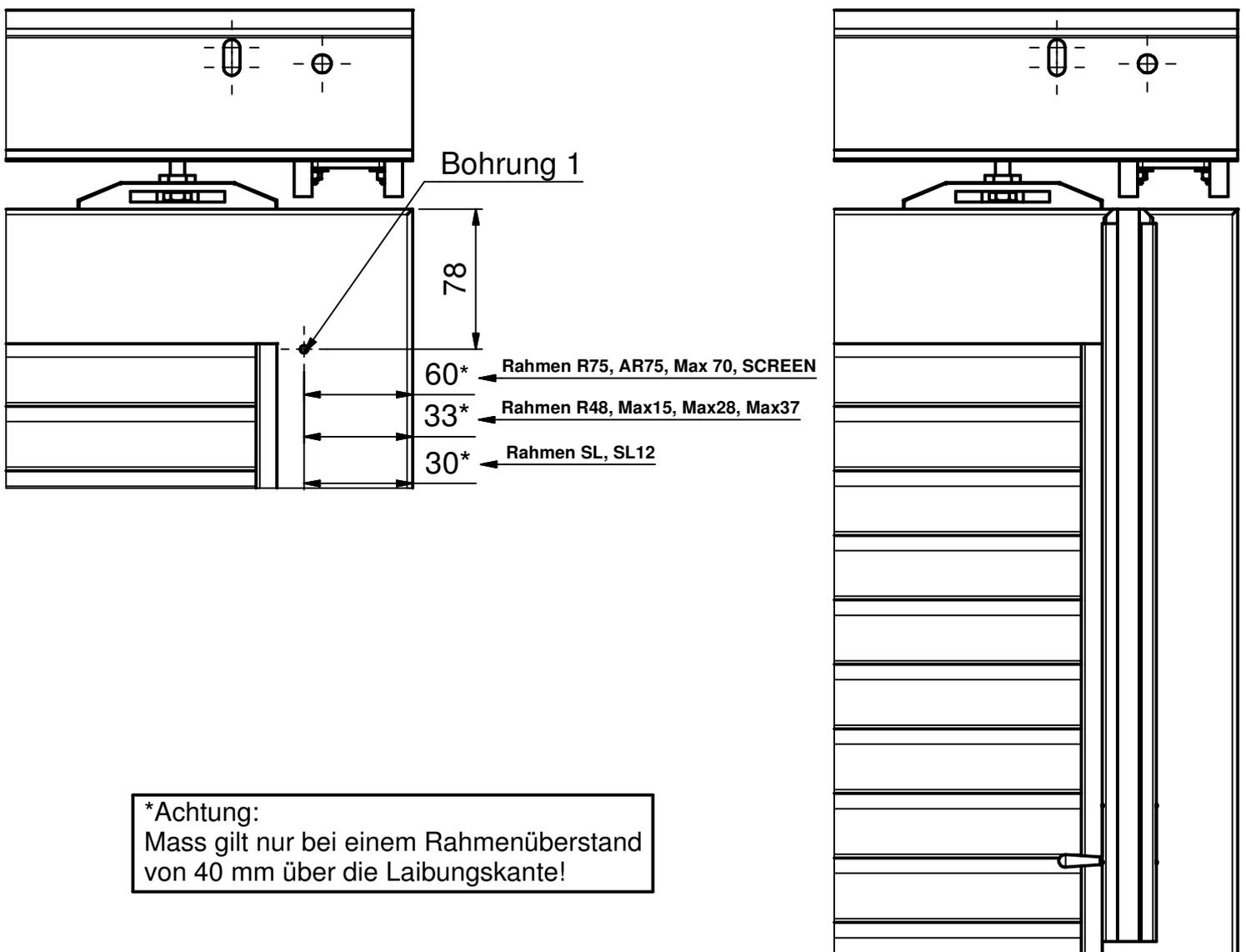
Befestigung des Verriegelungswinkels für den Schiebeladenriegel am Endstopper ( Eco ) für **Rahmenbreite 48 und kleiner**
