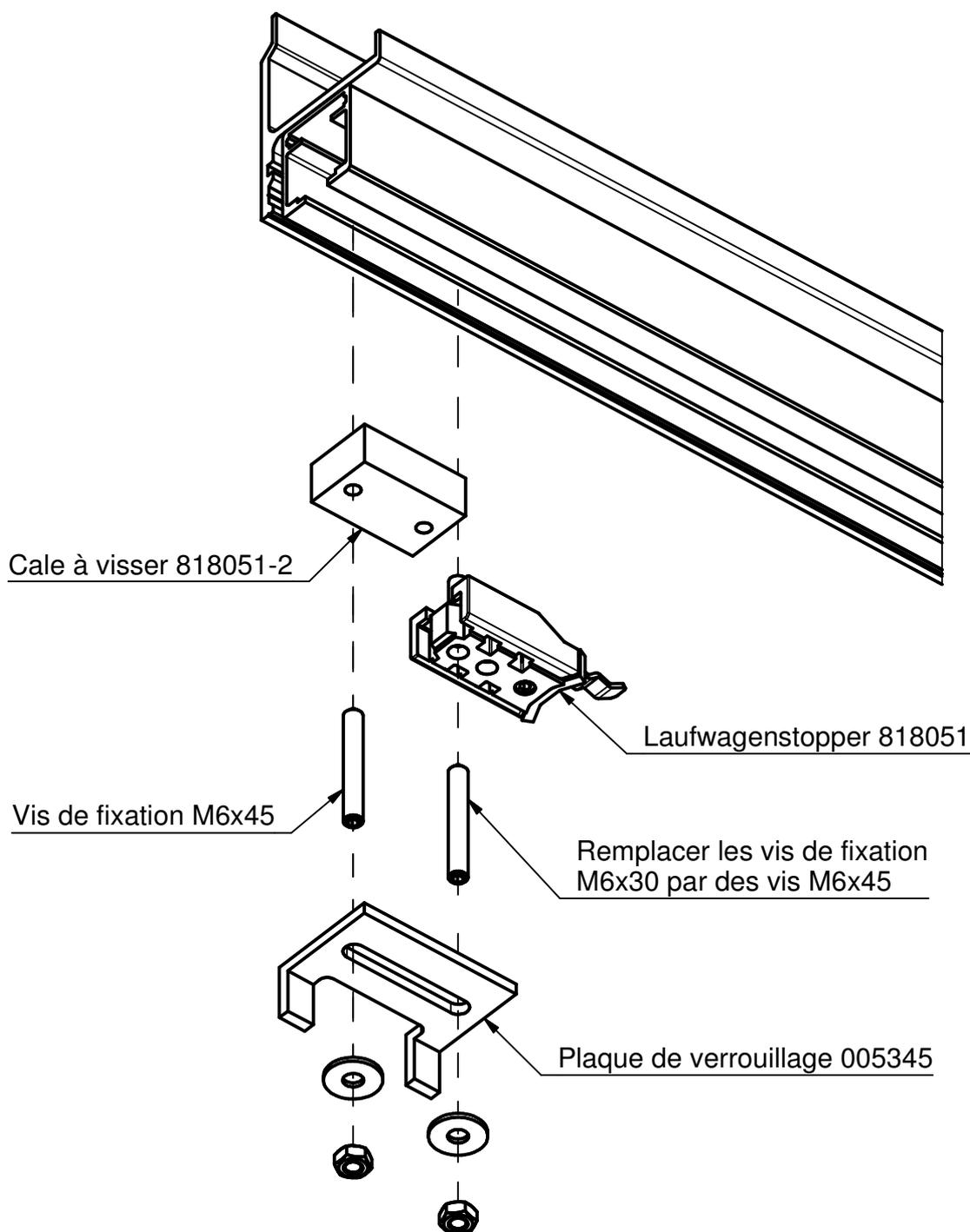
1. Remplacer la vis de fixation M6 de la butée de fin de course.
