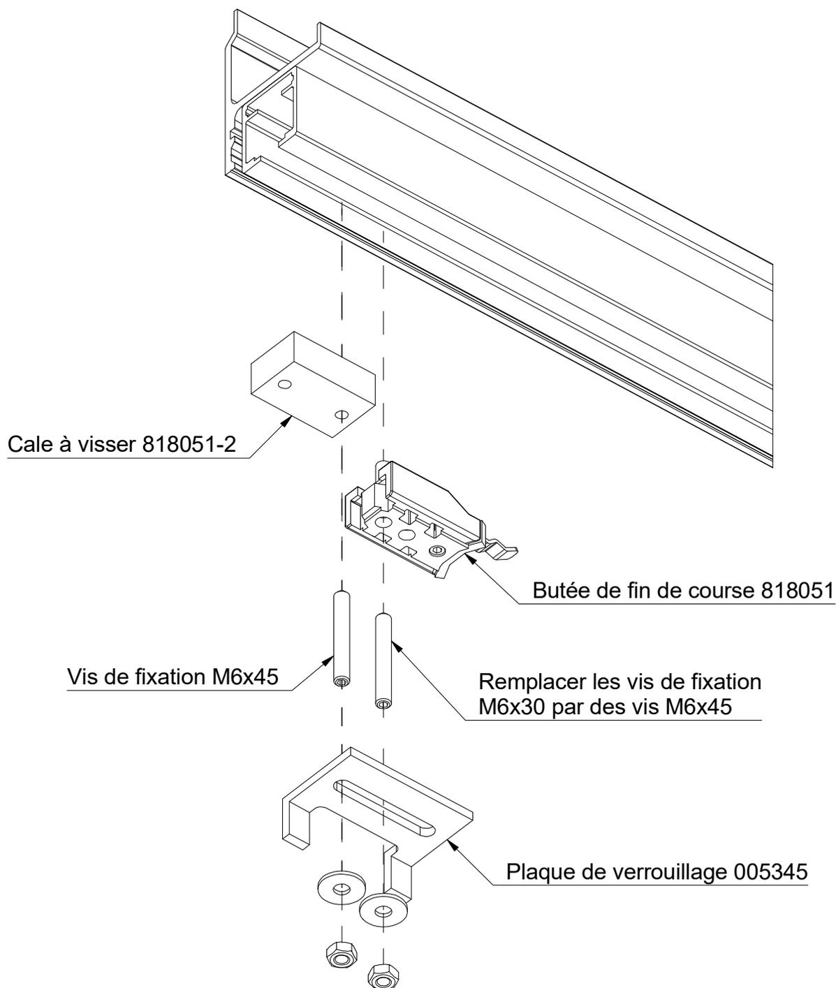
1. Remplacer la vis de fixation M6 de la butée de fin de course.
