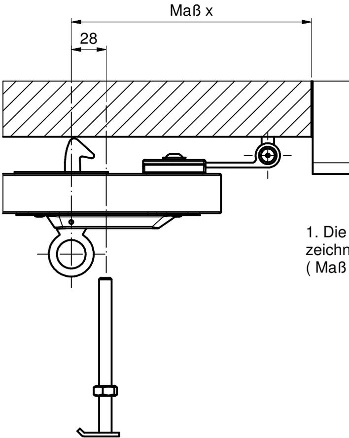
1. Die Mitte des Wind-/ Zugwindfallenhakens anzeichnen oder von der Laibungskante abmessen (Maß x)
