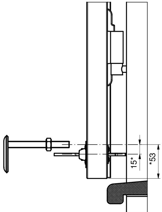
3. Klappladen öffnen und Windfallenklobenposition anzeichnen.
