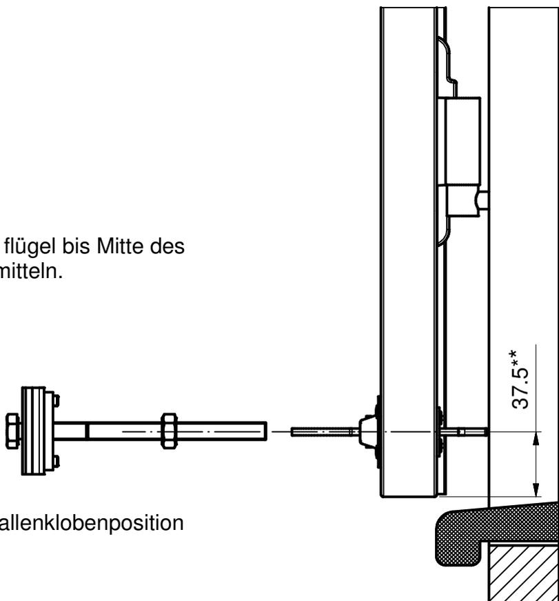
3. Klappladen öffnen und Windfallenklobenposition anzeichnen.
