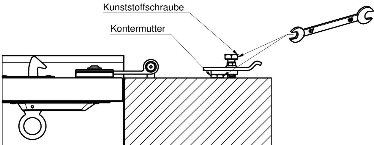
2. Kontermutter ( SW 17 ) anziehen und zuletzt die Kunststoffschraube so einstellen, daß der Klappladen an der Schraube anliegt und nur minimal Spiel zwischen Haken und Kloben besteht.
