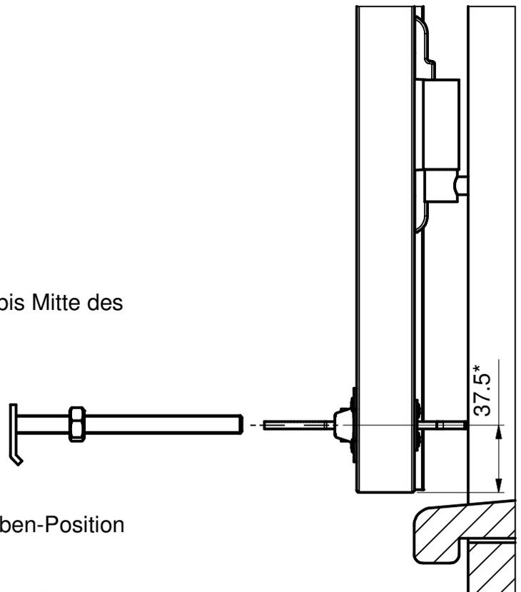
3. Klapppladen öffnen und Windfallenkloben-Position anzeichnen.
