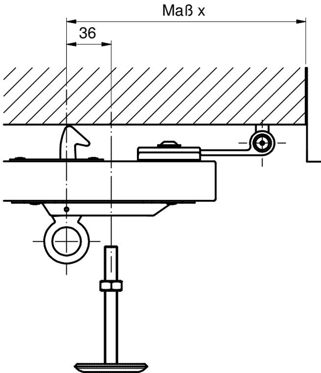
1. Die Mitte des Wind-/ Zugwindfallenhakens anzeichnen oder von der Laibungskante abmessen. ( Maß x )
