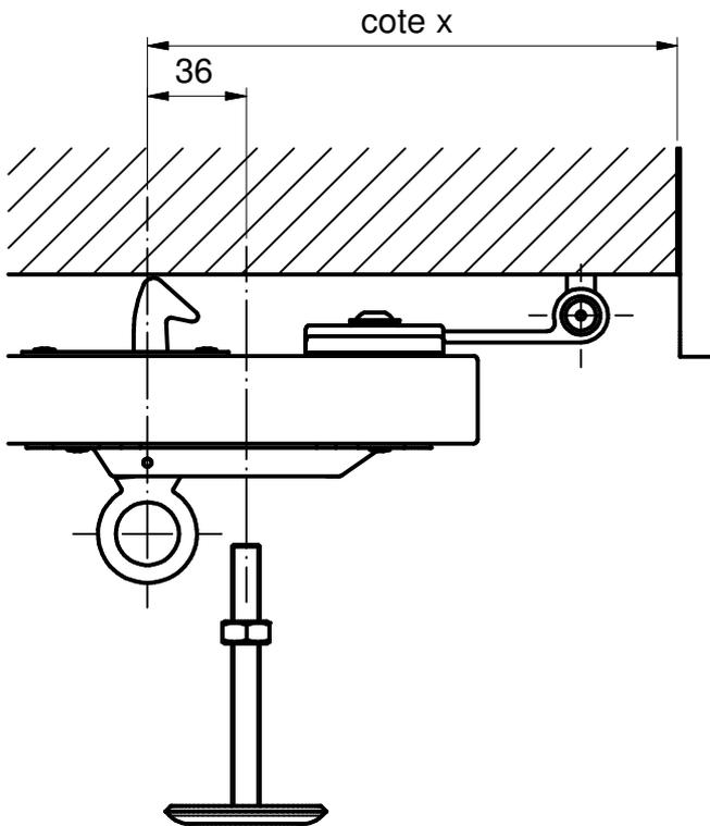
1. Tracer le milieu du crochet de l'arrêt à paillette ou relever la ( cote x )
