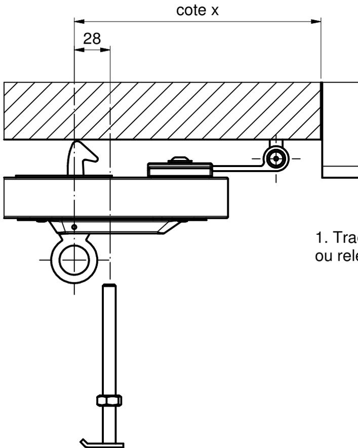
1. Tracer le milieu du crochet de l'arrêt à paillette ou relever la ( cote x )
