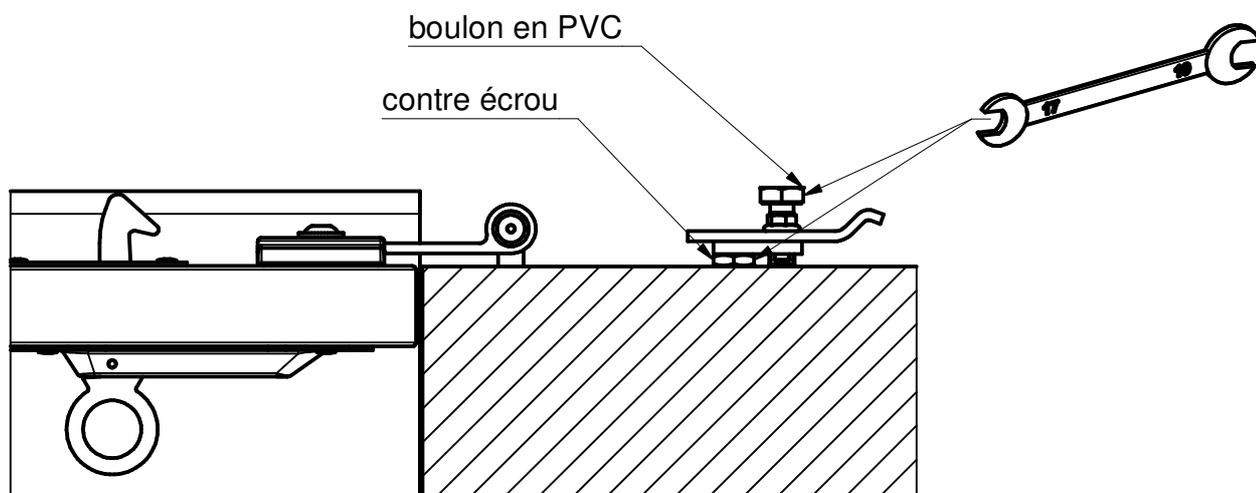
2. Serrer le contre écrou à l'aide d' une clé plate de 17.
