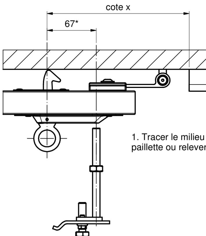
1. Tracer le milieu du crochet de l'arrêt à paillette ou relever ( cote x ).
