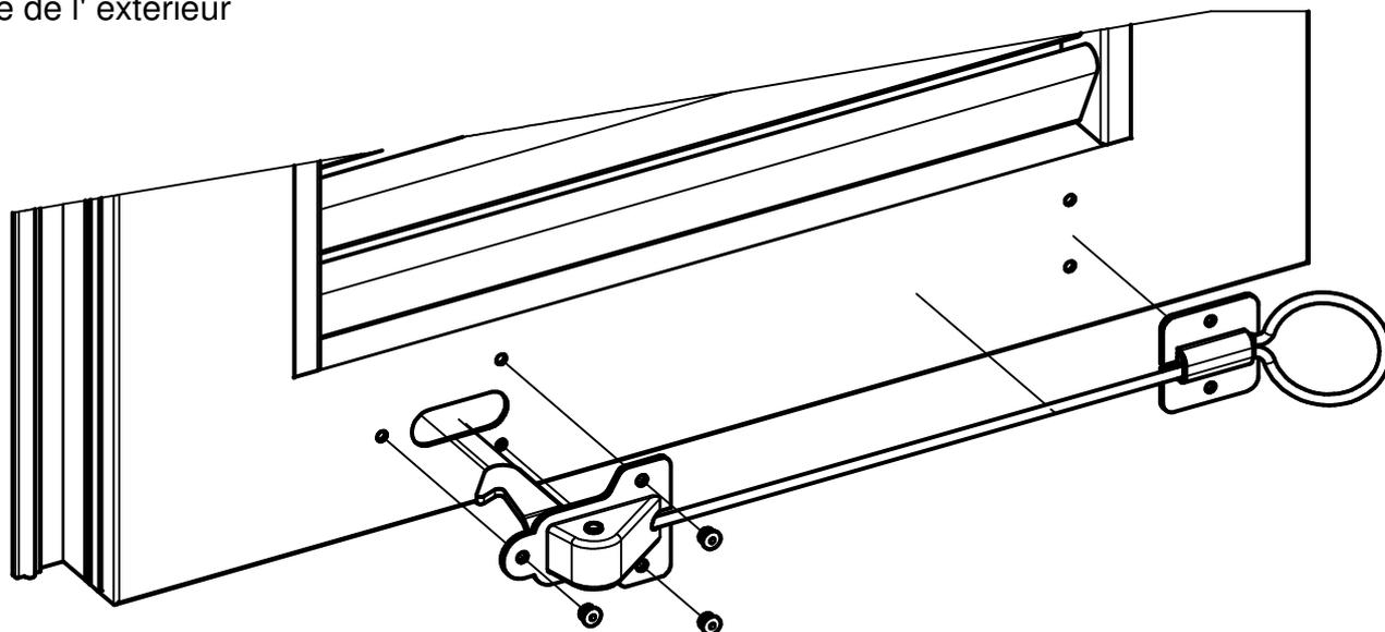
1. Accrocher la tige sur l'arrêt, positionner l'arrêt dans la fraisure de telle façon à avoir le plus grand débattement possible.
