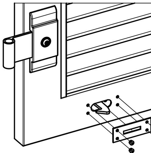
1. Positionner l'arrêt dans le fraisage de tel façon à avoir le plus grand débattement possible.
