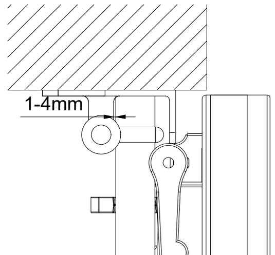
Un espace d'entre 1 et 4 mm doit être respecté entre la sécurisation du tableau et la barre de sécurité, de façon à pouvoir placer ou retirer la barre plus facilement.
