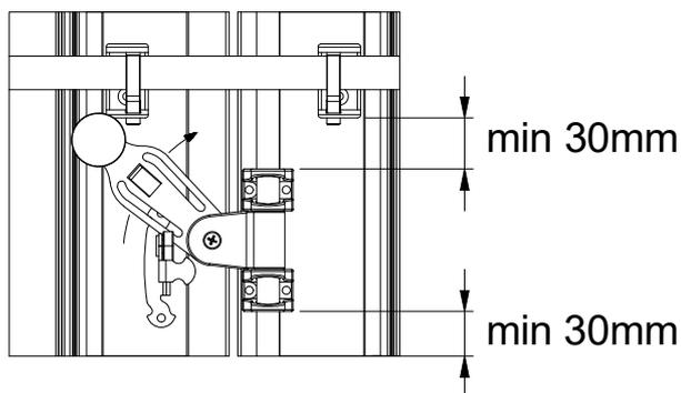
Le raccord en L avec pivot est à présent maintenu contre l'élément du haut et fixé.
