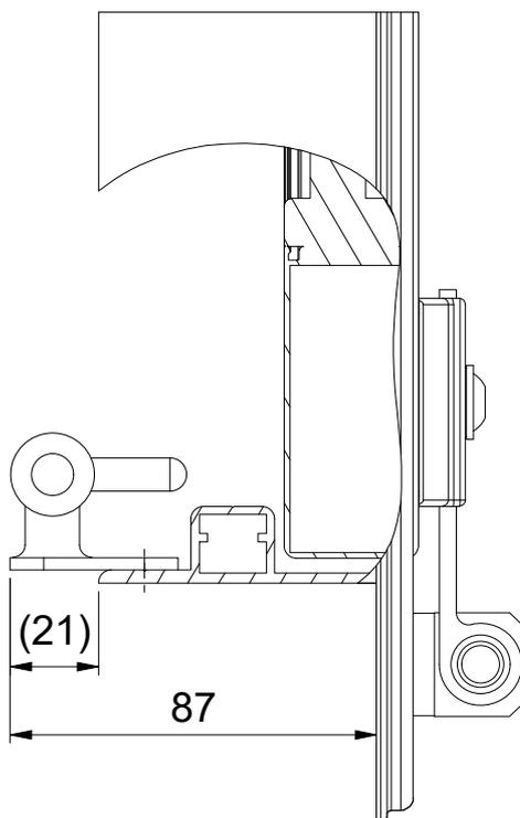
Profondeur tableau minimum avec montage sur maçonnerie
