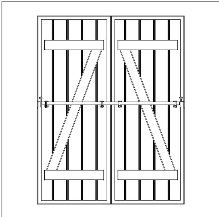
Fixer le support de la barre de sécurité sur la tôle. La hauteur de pose suffit pour éviter une collision entre la barre et la barre de sécurité, se reporter à la vue détaillée
