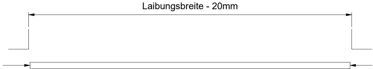
Couper la barre de sécurité 20 mm plus courte que la largeur du tableau, puis mettre en place des capuchons.
