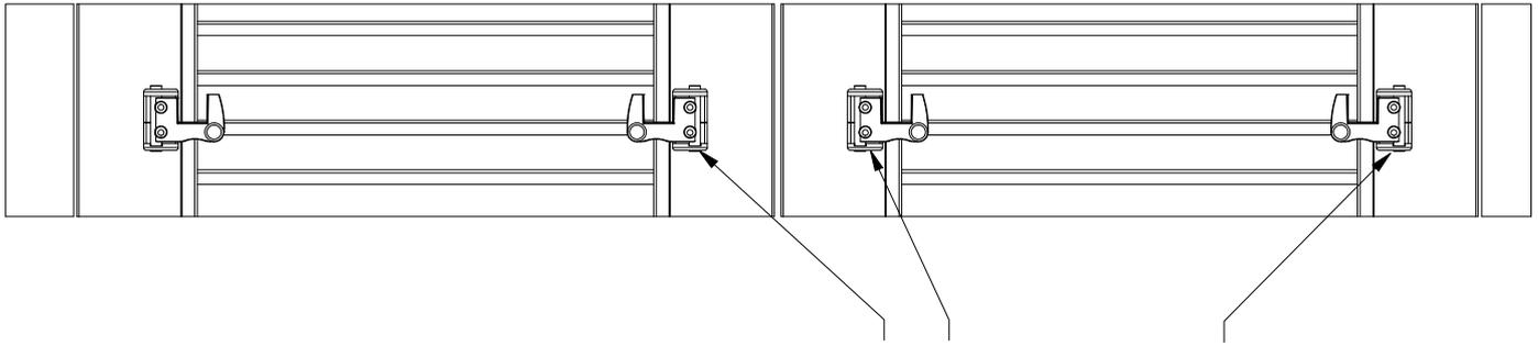
Procéder selon le même principe pour les autres supports, en veillant à tous les disposer suivant un alignement horizontal!
