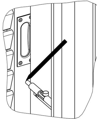
3. An der angezeichneten Stelle, wird nun mit einem kleineren Bohrer vorgebohrt.
