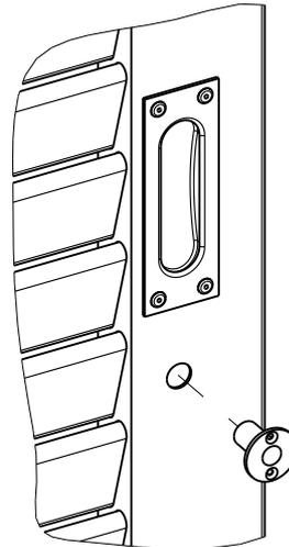
2. Buchse ausrichten und bohren ( Bohrer  $\varnothing$  3,2mm )
