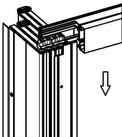
Amenez le paquet de lamelles jusqu' au bout du rail, abaissez-le avec précaution et décrochez-le.
