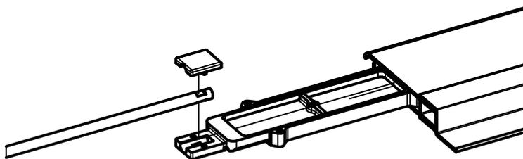
Enlevez la tringle de verrouillage, remplacez l'embase de la poignée et le guidage PVC.
