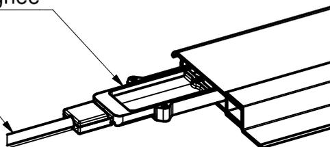
Sortir l'embase de la poignée par la tringle de verrouillage
