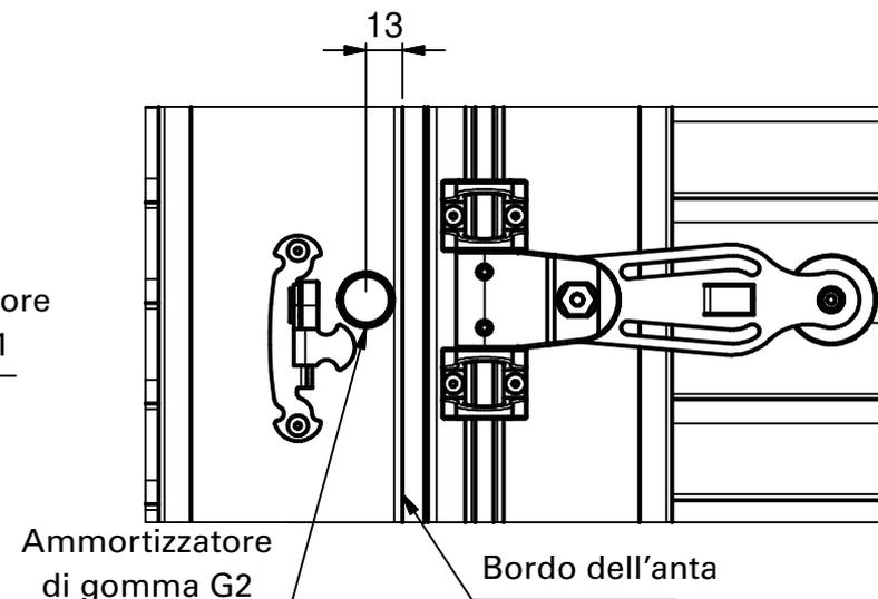
Montaggio della bussola conica per il fermo per persiana
