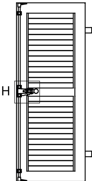
1. Allineare la maniglia e l'elemento di bloccaggio alla traversa orizzontale.
