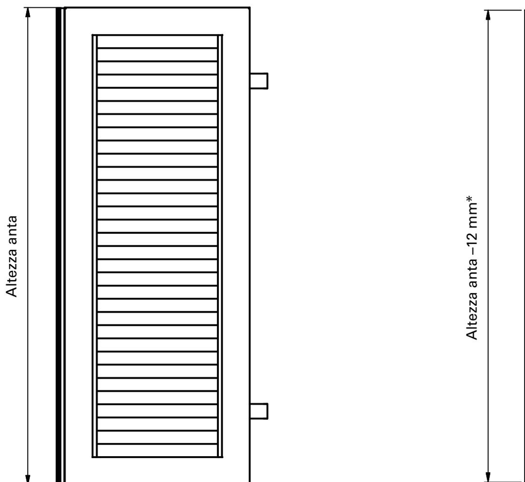
\*In caso di montaggio in una battentatura, occorre tener conto della profondità della battentatura stessa!
