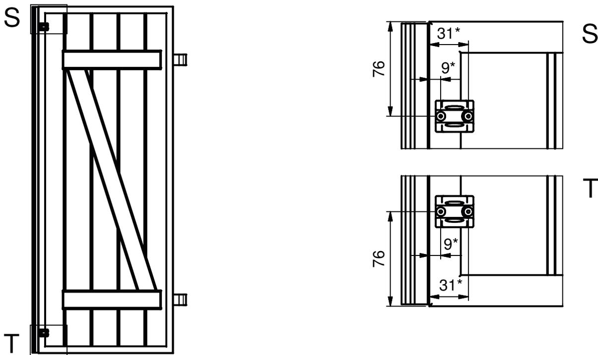
Montare le guide superiore e inferiore della barra girevole
