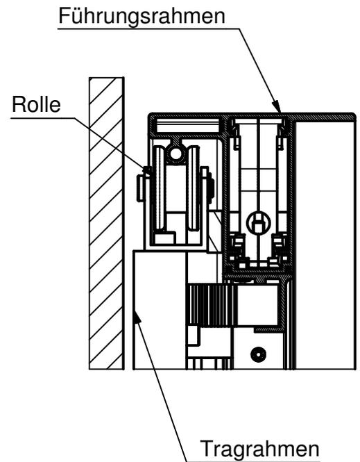
Führungsrahmen mittig in die Rollen des Tragrahmen einhängen.
