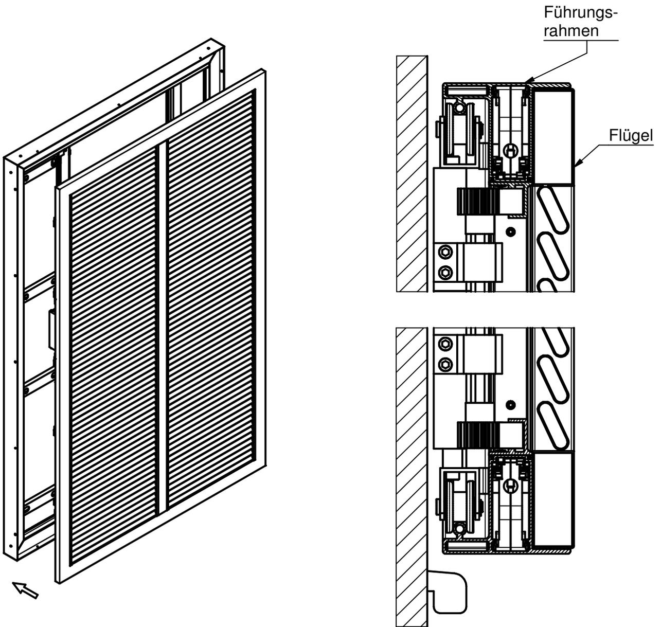
Flügel in Führungsrahmen stellen, ausrichten und befestigen.
