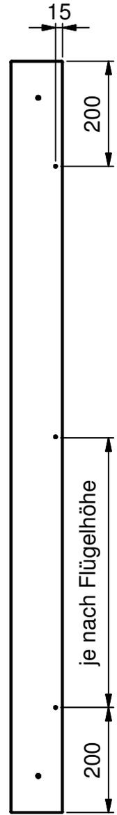
Befestigungsbohrungen für Einsatzflügel mit mitgelieferter Bohrschablone bohren!
