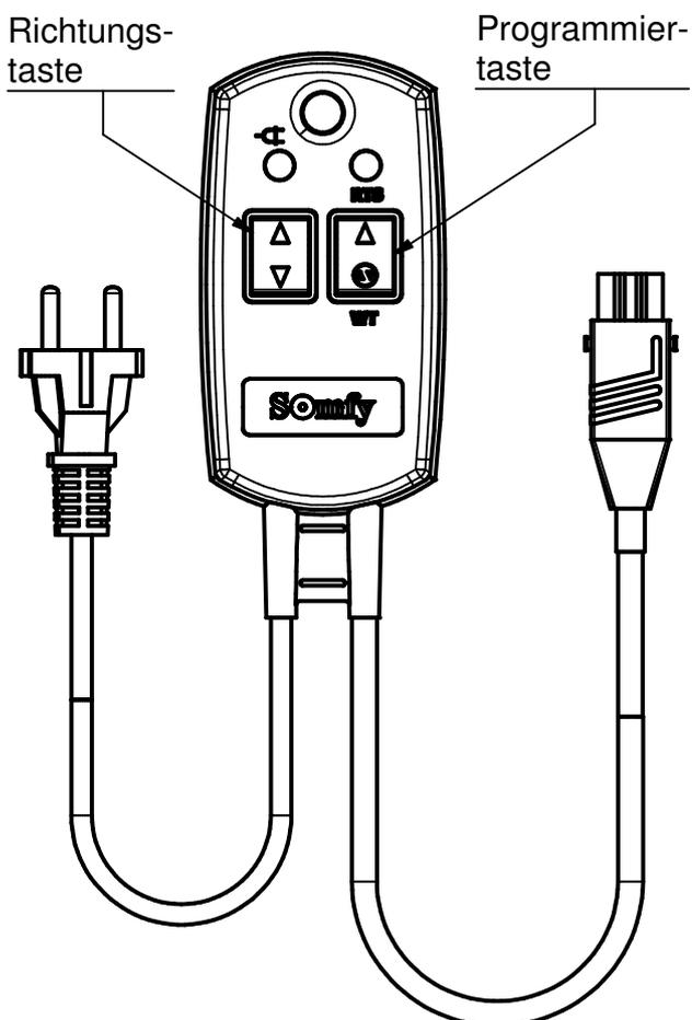
1. Programmierkabel mit Motor und Stromquelle verbinden
