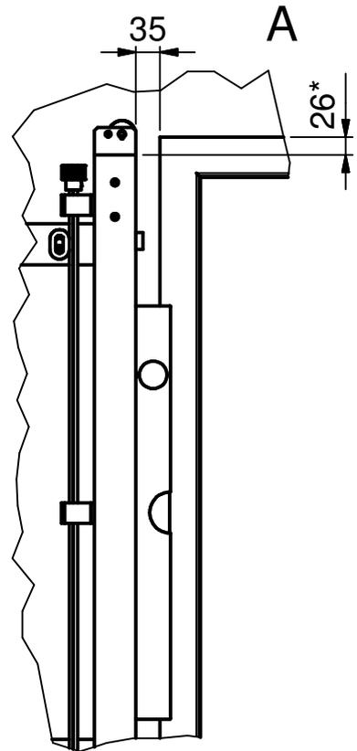
Tragrahmen positionieren und mit Wasserwaage ausrichten.
