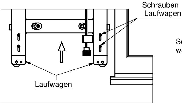
Schrauben an den Laufwagen lösen und Laufwagen bis zum Anschlag nach oben schieben
