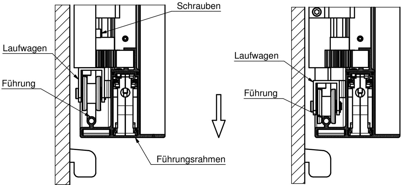
Schrauben lösen und beide Fahrwagen auf die Führung aufsetzen.
