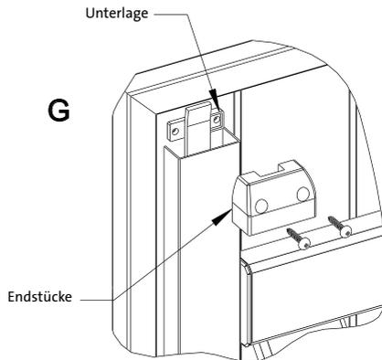
→ Die Unterlage unter der Riegelstange legen und die Endstücke über die Unterlage und das Abdeckprofil stecken.
