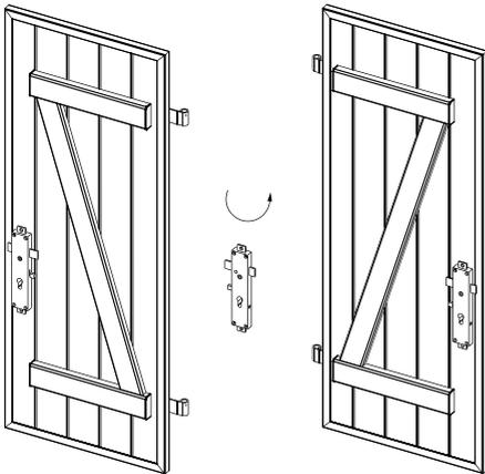
→ Durch Drehung des Schlosses um 180°, kann die Anschlagart (links/rechts) geändert werden.
