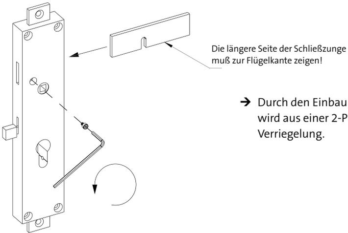
→ Durch den Einbau der Schließzunge, wird aus einer 2-Punkt eine 3-Punkt-Verriegelung.
