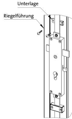
→ Maß einrichten, bohren und verschrauben
