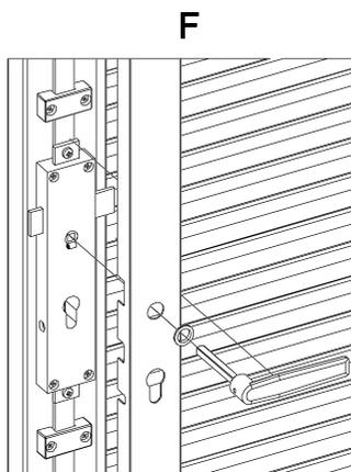
→ Emboîter le capot, utiliser la poignée ou le cylindre pour le centrage.
