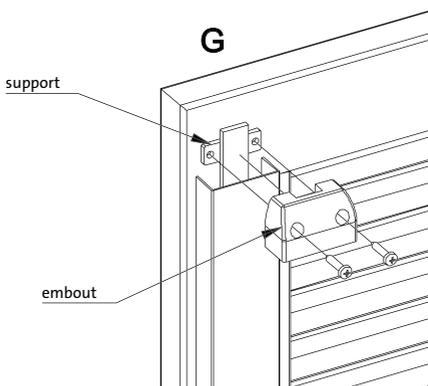
→ Glisser le support sous la tringle, emboîter l'embout, aligner et fixer.
