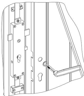
→ Emboîter le capot, utiliser la poignée ou le cylindre pour le centrage.
