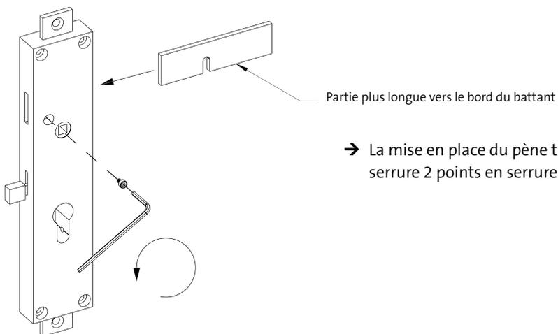
→ La mise en place du pène transforme la serrure 2 points en serrure 3 points
