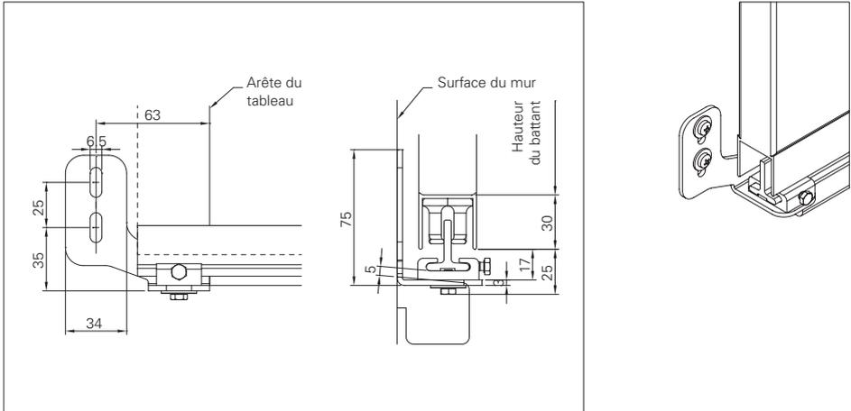
Trous de fixation équerre de guidage latérale type B, guidage continu contrecoudé, largeur de vue 34 mm
