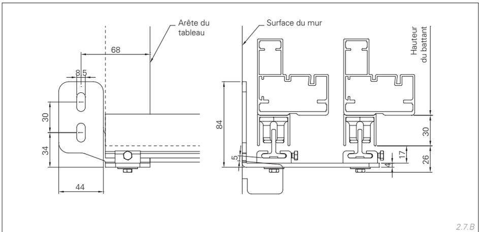
Trous de fixation équerre de guidage latérale type B, guidage continu contrecoudé, largeur de vue 44 mm
