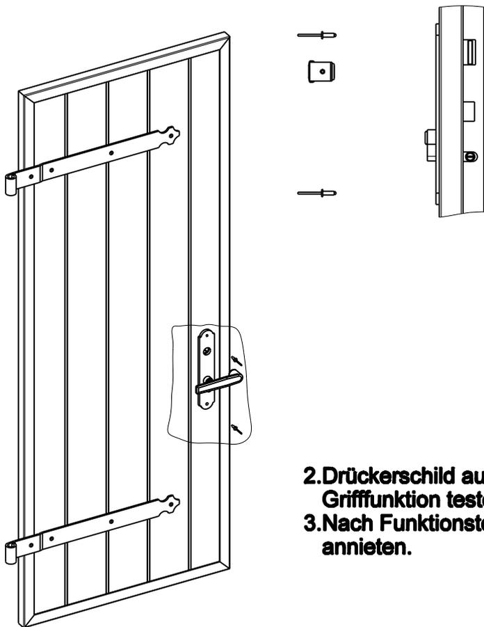
1. Drückerschild durch Einbau des kompletten Griffes und des Zylinders fixieren.
