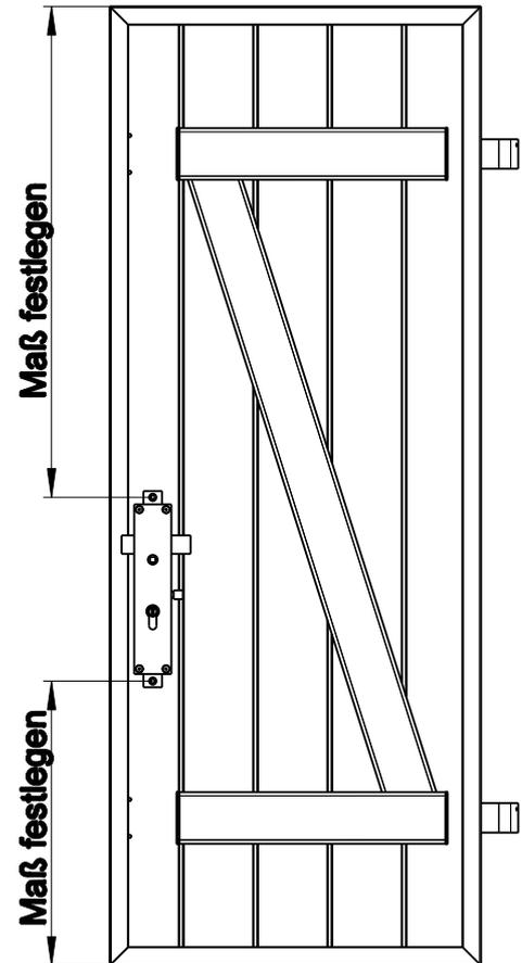
4. Danach Verriegelungsstange ablängen, entgraten und anschrauben.
