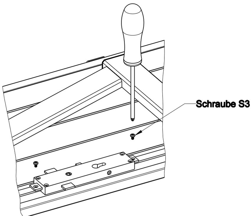
1. Unterlage der Riegelführung, unter der Riegelstange positionieren und die Riegelführung über die Unterlage stecken.
