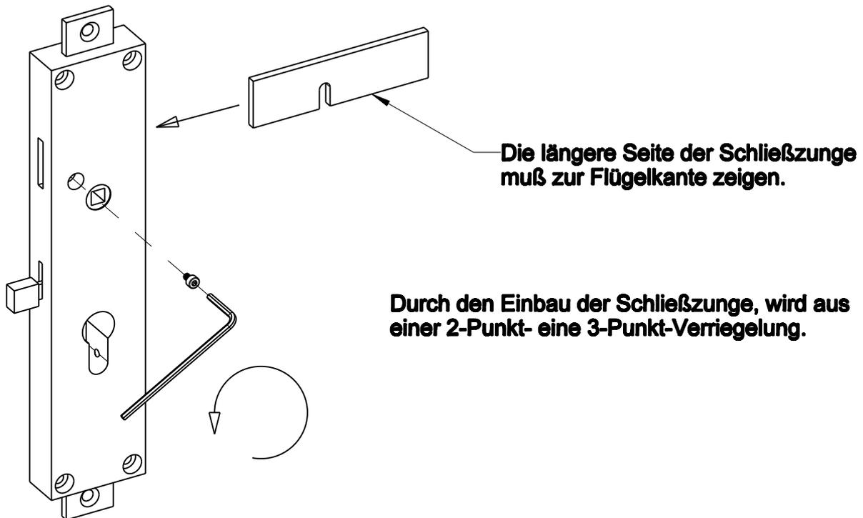
Durch drehen des Schlosses um 180°, kann die Anschlagart ( links / rechts ) geändert werden.
