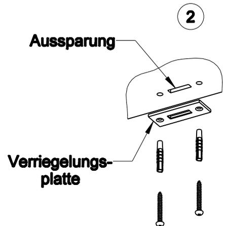
1. Flügel schließen und parallel zur Fassade ausrichten. Verriegelungsplatte anzeichnen.
