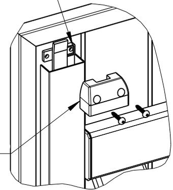
1. Die Unterlage unter die Riegelstange legen. Die Endstücke über die Unterlage und das Abdeckprofil stecken.
