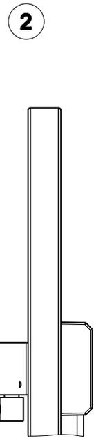
1. Flügel schließen und parallel zur Fassade ausrichten. Gummipuffer anbringen und Riegelanschlag wie in der Skizze anzeichnen.
