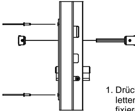
1. Drückerschild durch Einbau des kompletten Griffes und des Zylinders fixieren.
