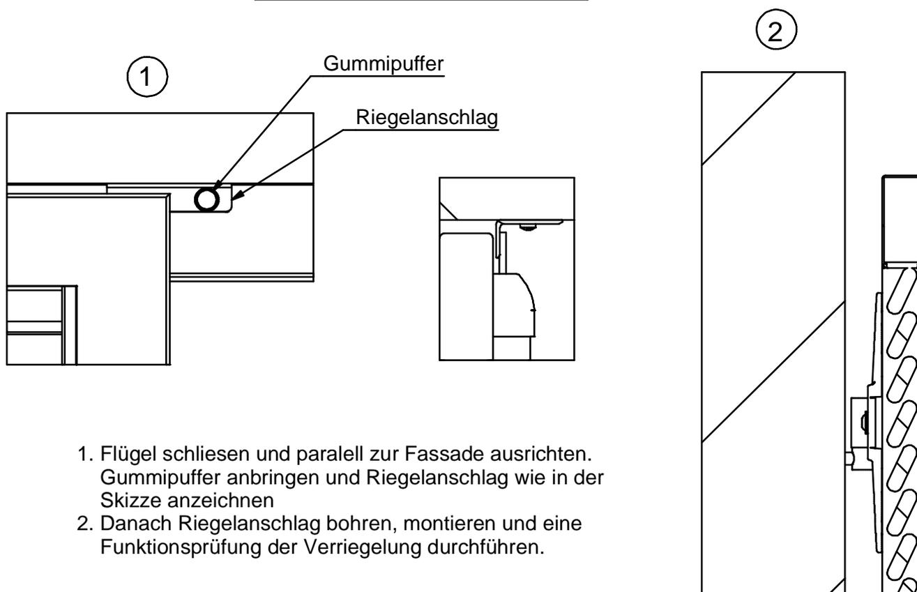
1. Flügel schliessen und parallel zur Fassade ausrichten.
