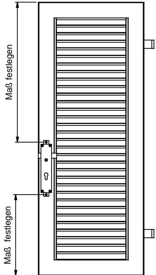
3. Danach die Verriegelungsstange ablängen, entgraten und anschrauben.
