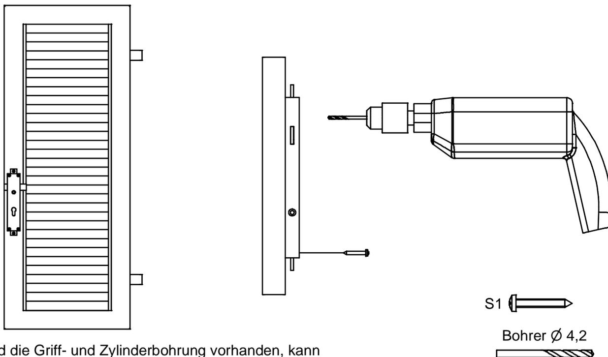
Sind die Griff- und Zylinderbohrung vorhanden, kann der Zylinder als Hilfsmittel eingesetzt werden.
