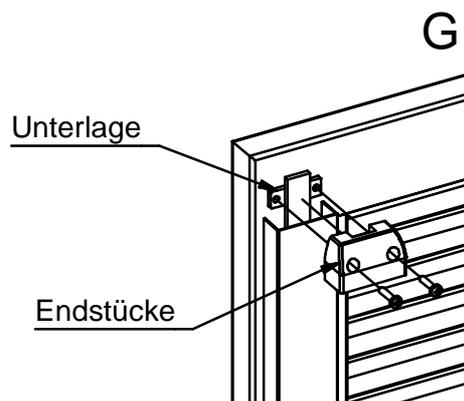
1. Die Unterlage unter der Riegelstange legen und die Endstücke über die Unterlage und das Abdeckprofil stecken.
