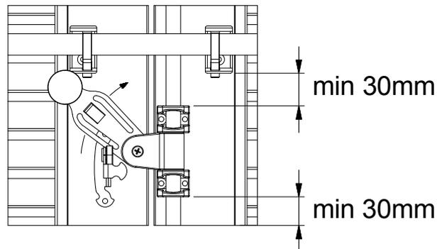
Das L-Stück mit Zapfen wird nun gegen das obere Bauteil gehalten und abgebohrt.
