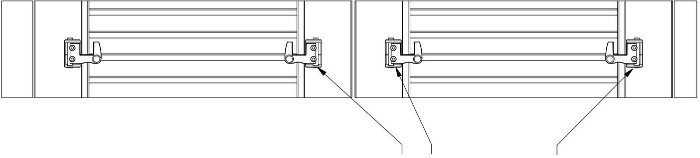
Die restlichen Halter nach dem gleichen Prinzip verbauen und darauf achten, das alle Horizontal in einer Flucht liegen!
