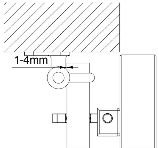
Zwischen der Laibungssicherung und der Burgstange sollten 1-4mm Luft eingehalten werden um die Burgstange einfacher einsetzen- oder rausnehmen zu können.
