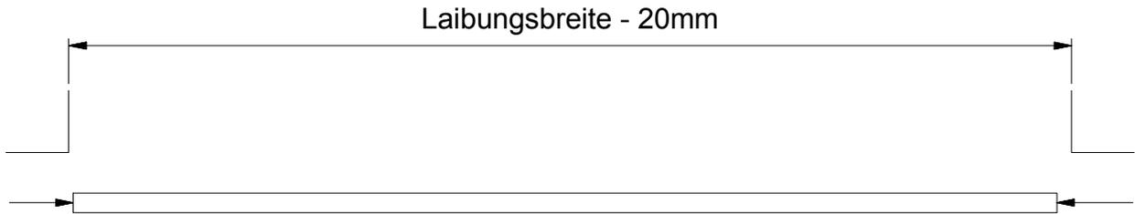
Die Burgstange 20mm kürzer als die Laibungsbreite zusägen und anschließend mit den Abdeckkappen versehen.
