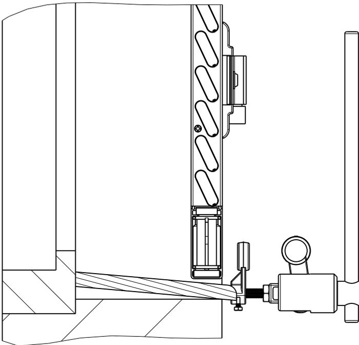
1. Der Ladenhalter sollte soweit eingedreht werden, bis der kippbare Kopf in eingerastetem Zustand den Klappplatten parallel zur Fassade fixiert.
