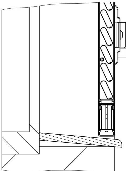
**2. Dübel in Bohrloch einschlagen und Ladenhalter mit dem geeigneten Eindrehwerkzeug einschrauben.**
