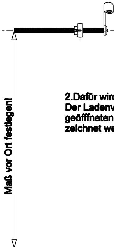
**2. Dafür wird der Klappladen geöffnet. Der Ladenvorreiber sollte nur in der geöffneten Klappladenposition angezeichnet werden!**
