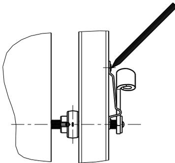
3. Das Streichblech anzeichnen. Höhe so festlegen, daß nach dem Festklemmen des Ladens der Schwenkbügel leicht schräg nach oben steht.
