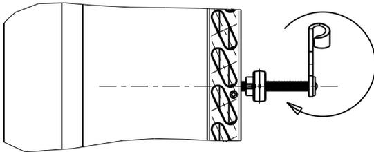
1. Den Ladenvorreiber mit Hilfe des Schwenkbügels einschrauben.
