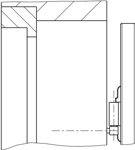
**1. Die Position des Ladenvorreibers kann erst nach der Montage des Klappladens festgelegt werden.**
