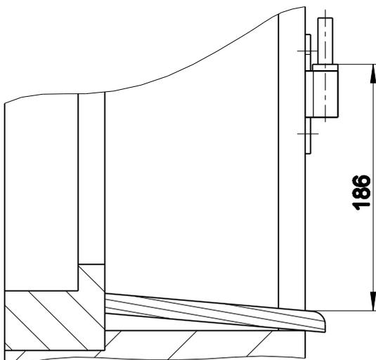
**2. Plattenkloben unten auf das Maß 186 mm von der Oberkante der Fensterbank und 35 mm von der Laibungskante positionieren. Danach können die Bohrlöcher angezeichnet werden.**
