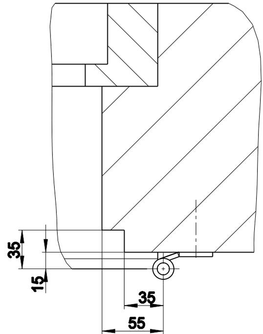
**1. Plattenkloben oben auf das Maß 226 mm von Unterkante Sturz und 35 mm von der Laibungskante ausrichten. Danach die Bohrlöcher markieren.**
