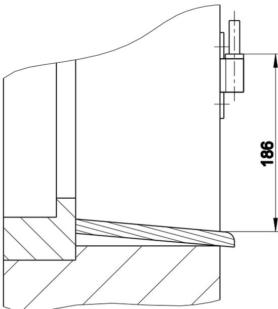
**2. Plattenkloben unten auf das Maß 186 mm von der Oberkante der Fensterbank und 35 mm von der Laibungskante positionieren. Danach können die Bohrlöcher angezeichnet werden.**
