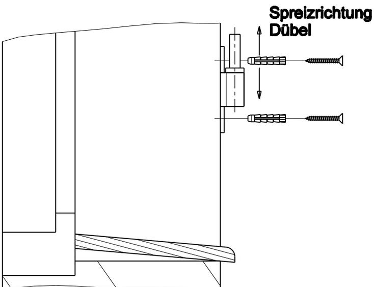
**Dübel in Bohrloch einsetzen und Plattenkloben anschrauben.
