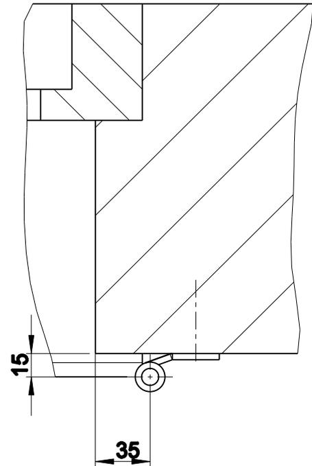
**1. Plattenkloben oben auf das Maß 226 mm von Unterkante Sturz und 35 mm von der Laibungskante ausrichten. Danach die Bohrlöcher markieren.**
