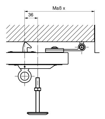
1. Die Mitte des Wind-/ Zugwindfallenhakens anzeichnen oder von der Laibungskante abmessen. ( Maß x )
