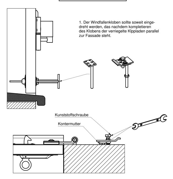
2. Kontermutter (SW 17) anziehen und zuletzt die Kunststoffschraube so einstellen, daß der Klappladen an der Schraube anliegt und nur minimal Spiel zwischen Haken und Kloben besteht.
