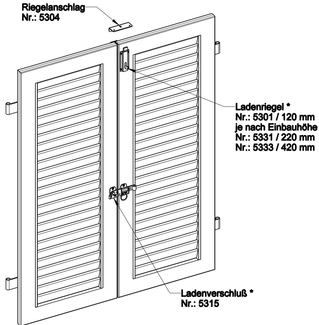
\* Bei diesen Artikeln kann zur Montage eine Ehret-Bohrschablone verwendet werden.
