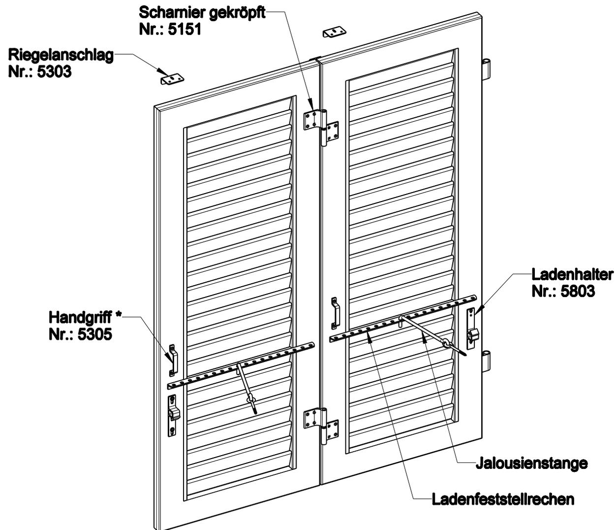
**\* Bei diesen Artikeln kann zur Montage eine Ehret-Bohrschablone verwendet werden.**
