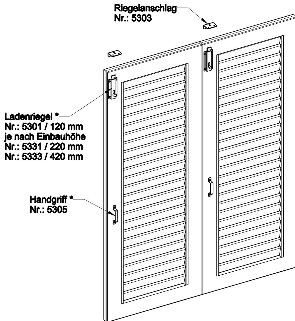
\* Bei diesen Artikeln kann zur Montage eine Ehret-Bohrschablone verwendet werden.
