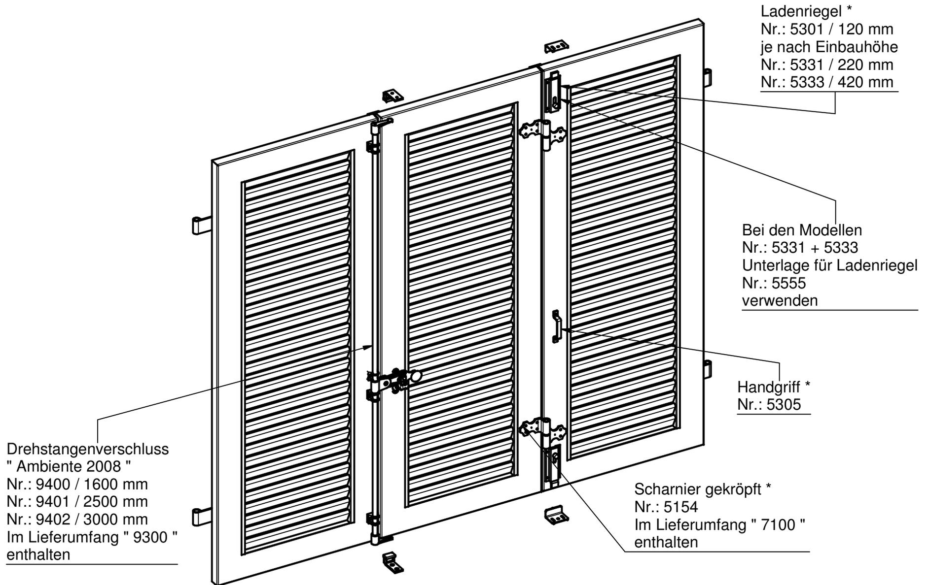
\* Bei diesen Artikeln kann zur Montage eine Ehret-Bohrschablone verwendet werden.
