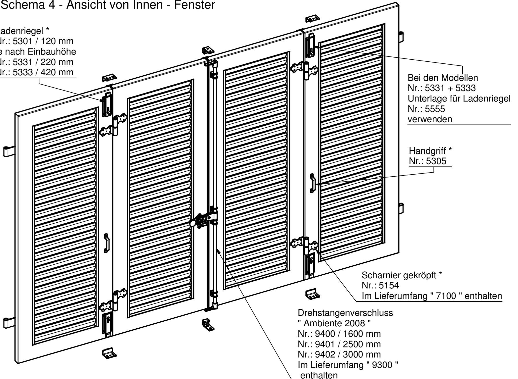
\* Bei diesen Artikeln kann zur Montage eine Ehret-Bohrschablone verwendet werden.
