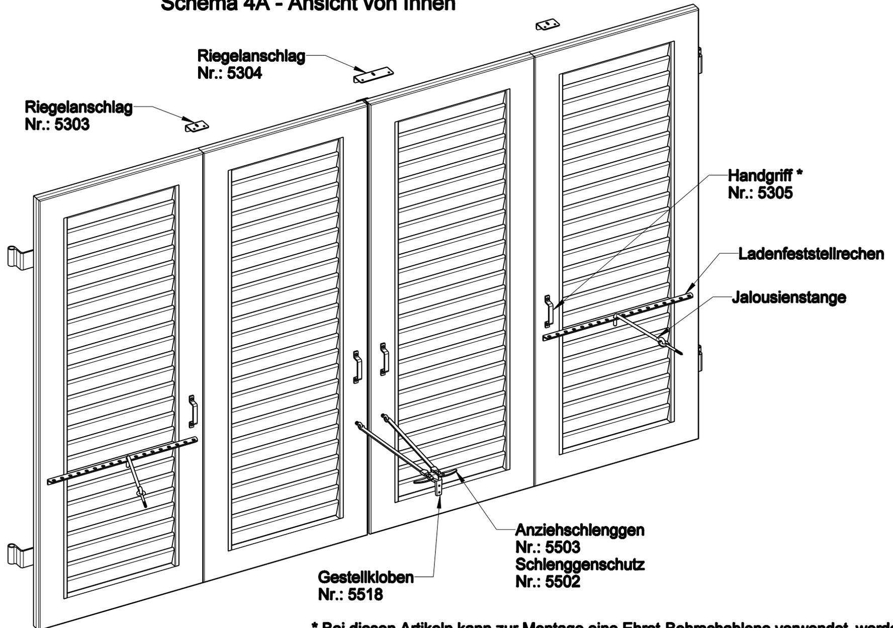
**\* Bei diesen Artikeln kann zur Montage eine Ehret-Bohrschablone verwendet werden.**
