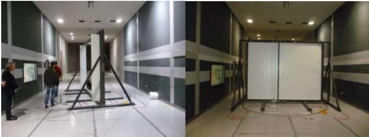
**Figure 3 : Les jalousies montées sur le banc, en position ouverte et fermée**
