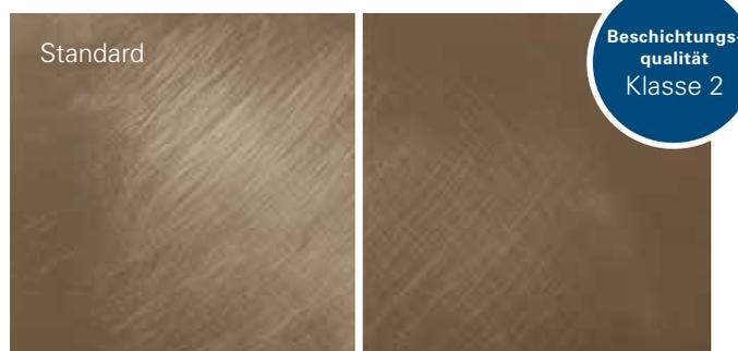
Geringere Kerbspuren nach Verkratzung messbar und sichtbar.
